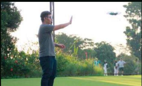
Spark dengan cermat akan mengikuti gerakan pengendalinya, asalkan telapak tangan mereka tetap terarah ke kamera *drone*. Untuk mengoperasikan Spark seperti itu, pengendali harus memilih Gesture Mode.
