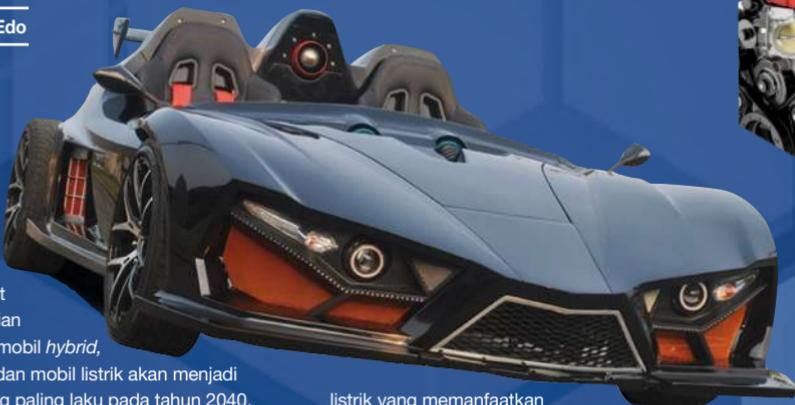
listrik yang memanfaatkan energi matahari. Sumber tenaganya berasal dari motor listrik berkekuatan 12 x 12 kw dengan menggunakan tenaga baterai lithium ion high capacity 97,2 volt dc, 15 kwh. Nantinya mobil ini akan dibawa jalan dengan jarak sekira 1.200 km dari Jakarta menuju Bali, dengan kondisi jalan dan laju lintas normal.
