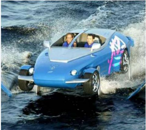
Rinspeed Splash dikenal sebagai mobil amfibi sekaligus mobil sport pabrikan Rinspeed di Swiss, yang dibuat pada tahun 2003 lalu. Rinspeed Splash mampu melaju hingga 200 km/jam di daratan, dan 45 knot di perairan. Dengan kekuatan mesin 750 cc, dua silinder, mesin turbo, 140 tenaga kuda, mobil ini mampu berakselerasi hingga 0-100 km/jam dalam 5,9 detik. Rinspeed Splash menjadi pusat perhatian pengunjung ketika dipamerkan untuk kali pertama di Geneva Motor Show 2004.
