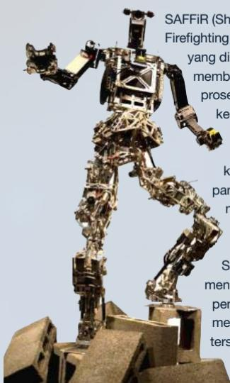
SAFFIR (Shipboard Autonomous Firefighting Robot) adalah robot yang diciptakan untuk membantu manusia dalam proses pemadaman kebakaran. Robot *humanoid* ini dilengkapi dengan kamera dan sensor panas sehingga mampu mendeteksi sumber api. Seiring berjalanannya waktu, SAFFIR dapat menggantikan tugas pemadam kebakaran, mengingat pekerjaan tersebut sangat berisiko dan berbahaya bagi manusia.
