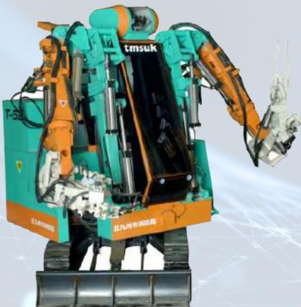
T-52 Enryu merupakan robot yang dikembangkan oleh dua perusahaan asal Jepang, yaitu TMSUK Co. Ltd. dan ROBO-GERAGE. Robot ini berfungsi untuk membantu manusia dalam penanganan
