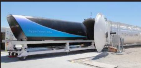
kompresor, yang bertugas untuk mengalirkan udara ke dalam tabung agar tidak menghambat jalannya kapsul. Kemudian, ada juga sistem *air bearing*. Dengan sistem inilah udara dari kipas angin dan kompresor akan ditampung.
