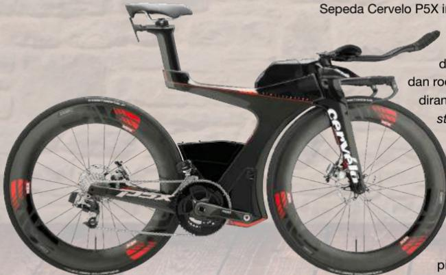
Sepeda Cervelo P5X ini diproduksi dengan bahan serat karbon serta gigi nirkabel SRAM Red eTap dan rem cakram hidrolik dan roda ENVE. Sepeda ini tidak dirancang dengan penampilan *stylist*, akan tetapi jika Anda menggunakan untuk sebuah transportasi yang ingin mendapatkan kecepatan tertentu, maka sepeda Cervelo P5X yang spesifik dengan balapan triathlon adalah pilihan yang tepat. Dengan kecanggihan teknologi diatas, jika Anda berminat bisa menyiapkan dana kisaran Rp 190 juta.
