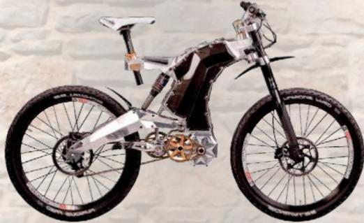
Sepeda M55 ini adalah salah satu sepeda listrik yang terbuat dari bahan material titanium, karbon fiber, dan *CNC-machined* aluminium. Desain sepeda ini terlihat cukup gagah dan kekar, terlihat dari rangka yang tebal serta ringan, shock depan, dan juga lengan ayun yang lebar membuat tampilan yang kokoh serta tangguh dalam menghadapai berbagai kondisi alam. Untuk hal itu sepeda ini dibandrol dengan harga Rp 460 juta.
