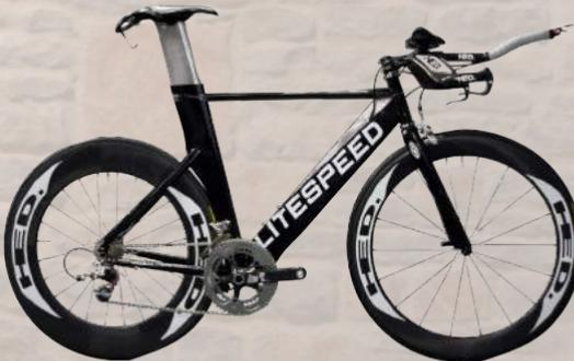
Sepeda Litespeed ini merupakan salah satu sepeda inovatif terbaik karena didukung berbagai karakteristik yang hebat. Salah satunya, rangka dari sepeda ini memakai konstruksi dari serat karbon dan logam titanium yang membuatnya berbeda. Namun, sempat diperbincangkan, masalah bahan titanium ini dianggap tidak cocok untuk digunakan sebagai rangka sepeda.
